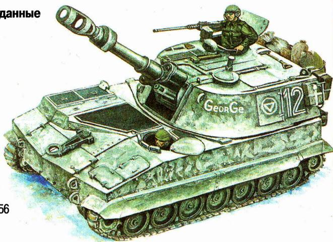
175-мм артиллерийская установка M107 поступила на вооружение армии США в 1961 году и разрабатывалась в качестве мощной самоходной пушки, приспособленной для транспортировки по воздуху. Перед погрузкой ее разбирали: на одном самолете везли шасси, на другом — артчасть.
