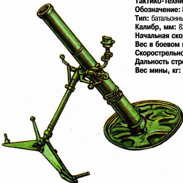
**Тактико-технические данные****Обозначение:** 82-мм миномет обр. 1941 г.**Тип:** батальонный миномет**Калибр, мм:** 82**Начальная скорость мины, м/с:** 211**Вес в боевом положении, кг:** 52**Скорострельность, выстр./мин:** 25–30**Дальность стрельбы, м:** 3040**Вес мины, кг:** 3,1
