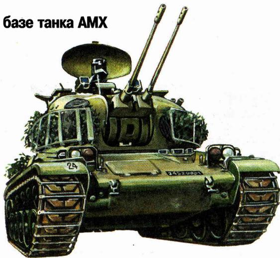
Приняв решение о создании самоходной зенитной установки, французские инженеры взяли за основу ходовую часть легкого танка АМХ-13, массово выпускавшегося с 1952 года. На его корпусе вместо башни вначале смонтировали счетверенную установку 20-мм автоматических пушек «Эрликон». Стрельба велась с помощью радиодальномера и счетно-решающего устройства.
