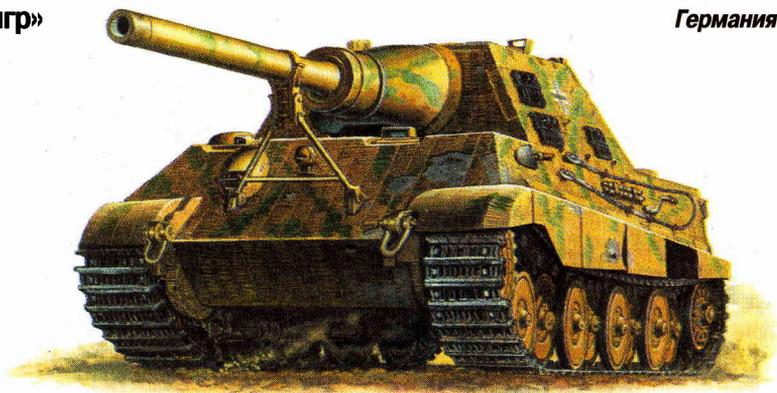
Практически все немецкие танки в годы Второй мировой войны использовались в качестве базы для создания самоходных артиллерийских установок. Не стал исключением и самый мощный серийный танк вермахта «Тигр» II, на шасси которого разработали противотанковую САУ под названием «Ягдтигр».
