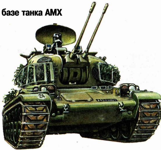
Приняв решение о создании самоходной зенитной установки, французские инженеры взяли за основу ходовую часть легкого танка AMX-13, массово выпускавшегося с 1952 года. На его корпусе вместо башни вначале смонтировали счетверенную установку 20-мм автоматических пушек «Эрликон». Стрельба велась с помощью радиодальномера и счетно-решающего устройства.
