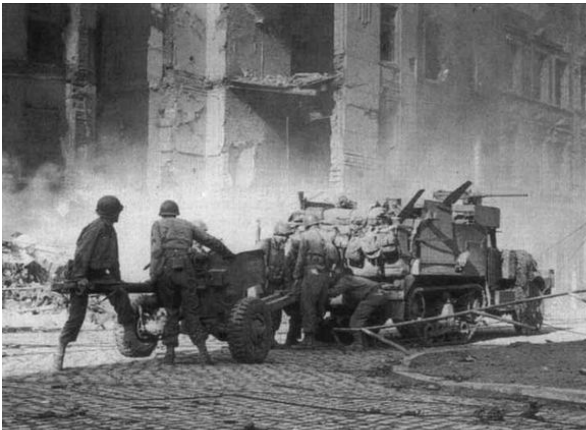
Расчет готовит к бою 57-мм пушку М1, буксировщиком которой является бронетранспортер М2А1. Германия, октябрь 1944 года
