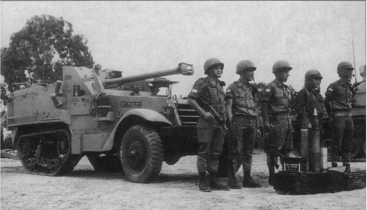
На вооружении нескольких противотанковых подразделений ЦАХАЛа во время войны 1967 года состояли "хаф-трэки", оснащенные 90-мм бельгийскими пушками Mесар
