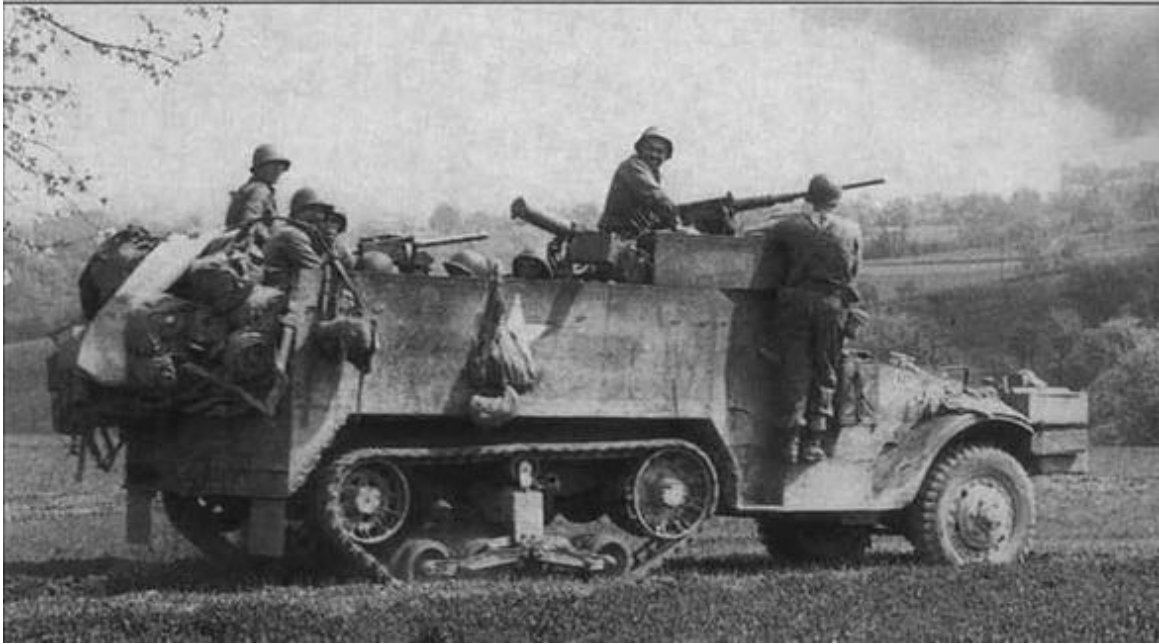
Бронетранспортер М3А1 из состава 61-го мотопехотного полка 10-й американской танковой дивизии. Германия, апрель 1945 года. Помимо штатных, на правом борту машины установлен 7,62-мм пулемет Browning М1917А1 с водяным охлаждением
