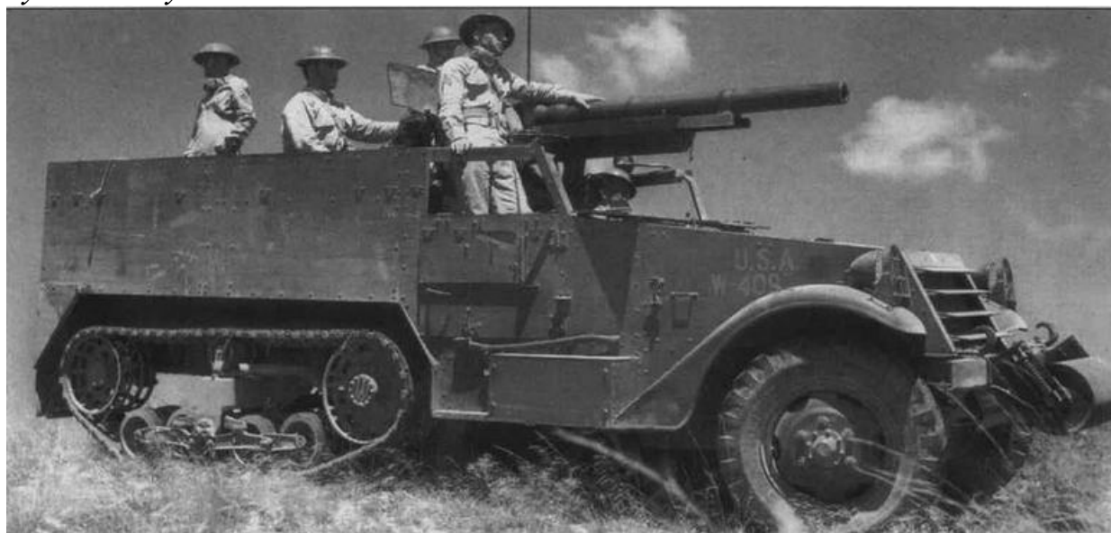
Истребитель танков М3 ранних выпусков с маленьким орудийным щитом
