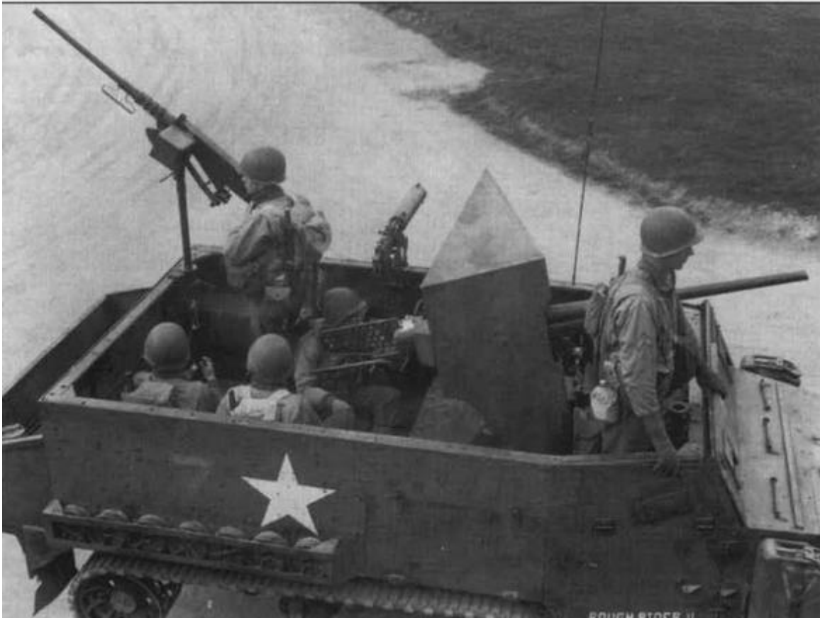
Бронетранспортер М2 из состава 41-го мотопехотного полка, довооруженный 37-мм пушкой, демонтированной с истребителя танков М6
