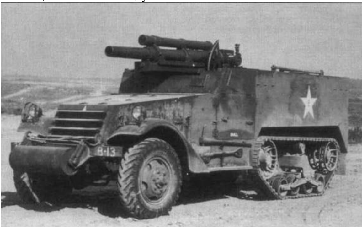
Самоходная установка Т19 — 105-мм гаубица М2А1 на шасси бронетранспортера М3
