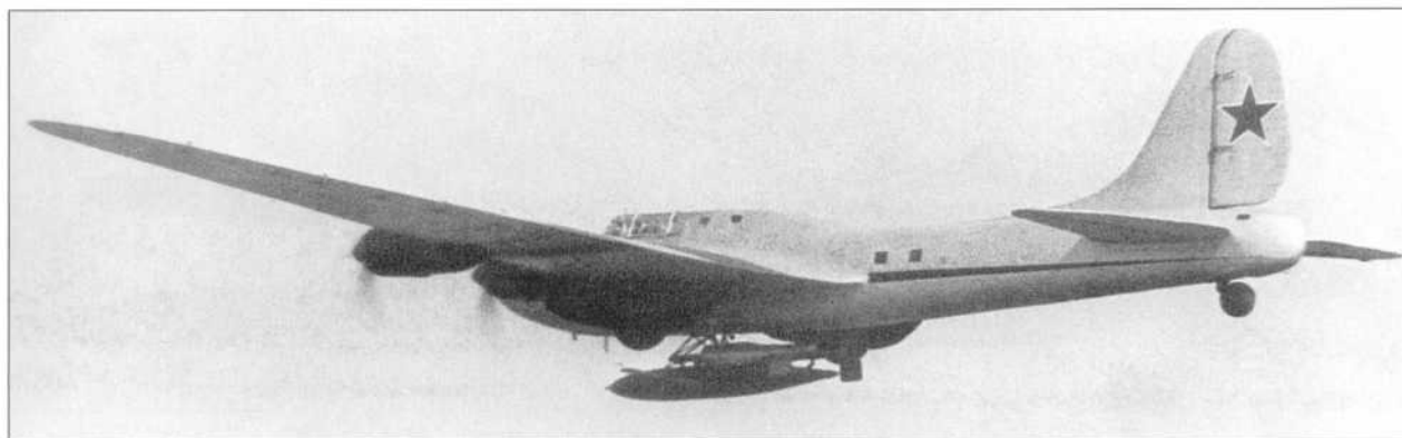
Летающая лаборатория Пе-8 4АШ-82 для испытаний ракет Челомея
