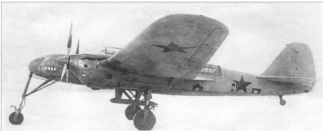
СБ с трехколесным шасси
