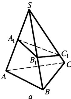
$$\frac{V_{SA_1B_1C_1}}{V_{SABC}} = \frac{SA_1 \cdot SB_1 \cdot SC_1}{SA \cdot SB \cdot SC}$$
