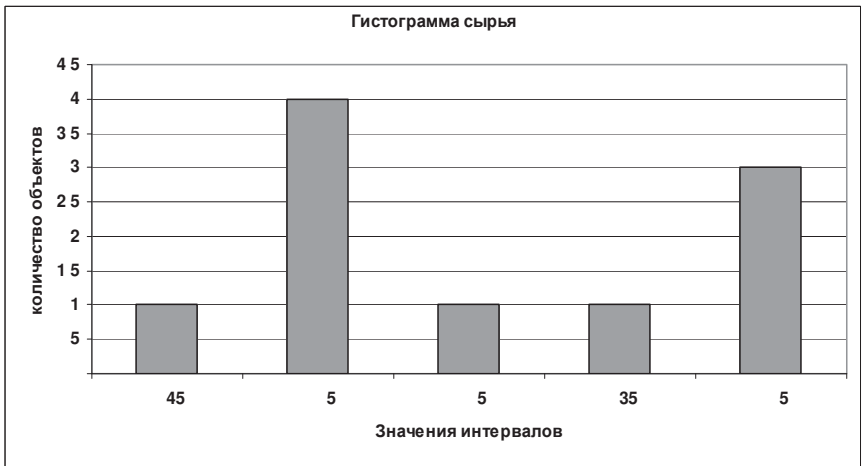
Рис. 2.33. Гистограмма качества сырья до обработки, которая служит для обнаружения стратификации показателя сырья
