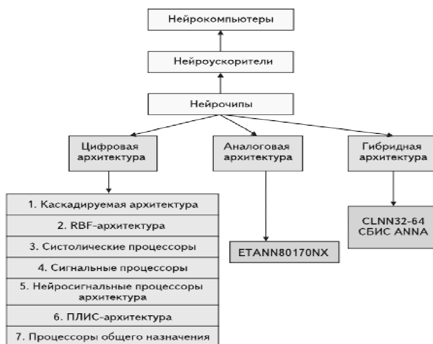
Рис. 2.6. Классификация нейросетевых архитектур по типу элементной базы
