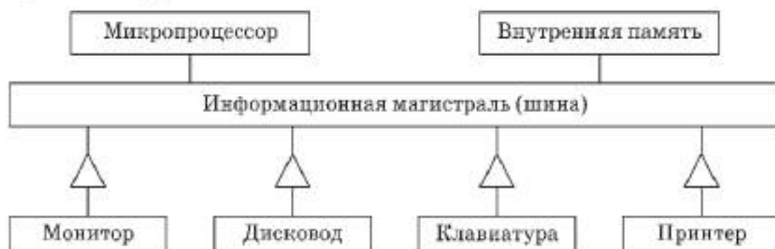
Рис. 10.2 Архитектура персонального компьютера
