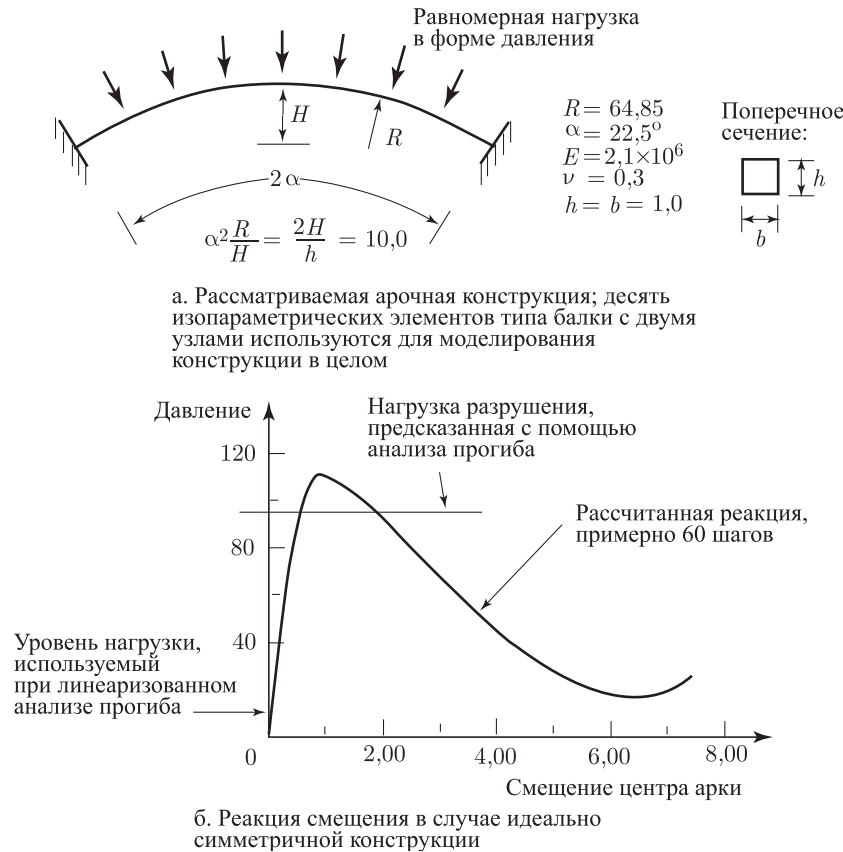
Рис. 6.39. Анализ разрушения арочной конструкции
