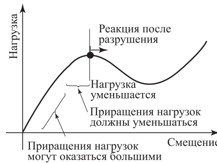
Рис. 8.21. Реакция с разрушением для конструкционной модели
