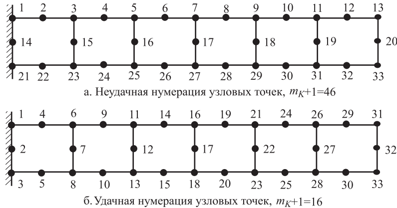
Рис. 12.4. Удачная и неудачная нумерация узловых точек для группы конечных элементов
