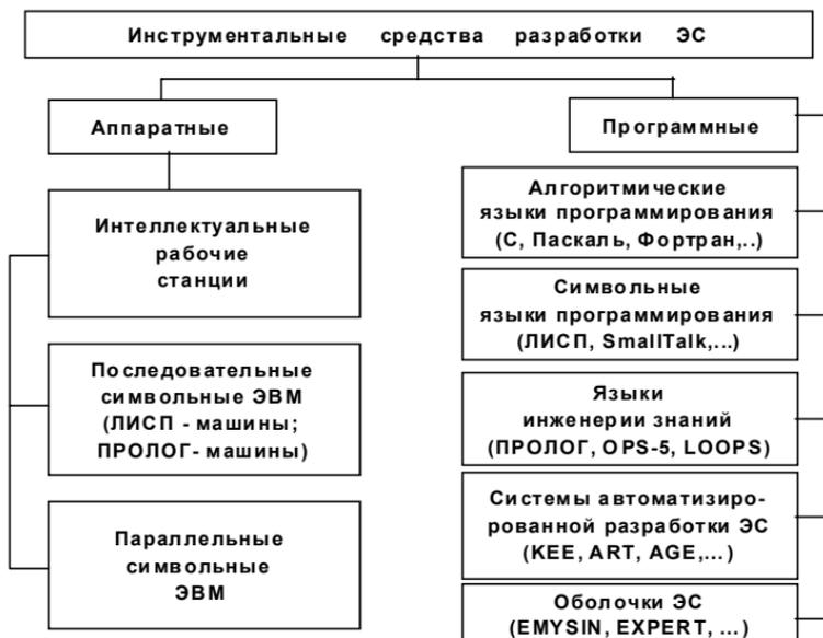
**Рис. 10.3.4.** Инструментальные средства разработки экспертных систем
