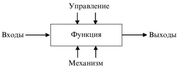
**Рис. 8.3.1.** Функциональный блок и интерфейсные дуги
