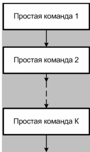
**Рис. 8.2.8.** Блок-схема команды следования
