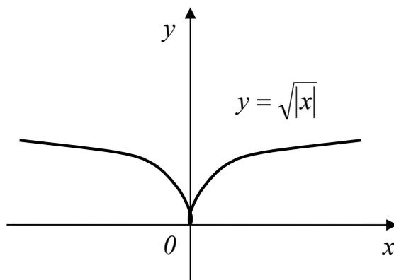
В качестве примера приведем функцию  $y = \sqrt{|x|}$ . В точке  $x=0$  производная этой функции  $y'(0) = 1/2\sqrt{|x|} = \infty$  не существует, хотя функция и непрерывна в этой точке.
