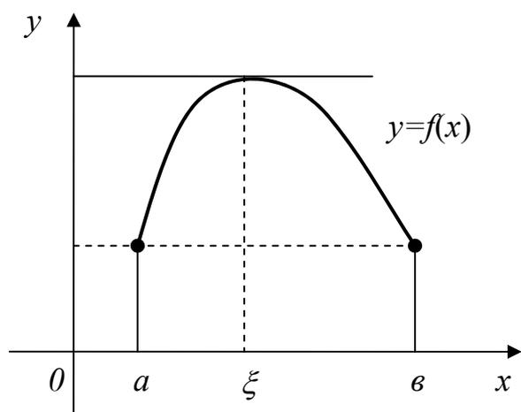
Геометрический смысл теоремы Ролля: при выполнении всех условий теоремы существует значение  $\xi \in (a, b)$  такое, что касательная к графику функции  $y = f(x)$  параллельна оси  $Ox$ .
