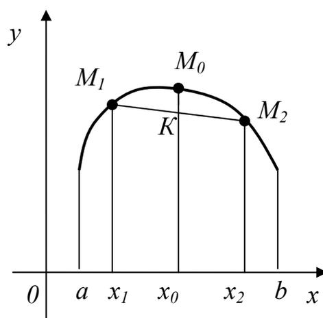
Геометрическая интерпретация понятия выпуклости функции: пусть  $M_1, M_2, M_0$  — точки графика функции  $y = f(x)$  с абсциссами  $x_1 < x_2$ ,  $x_0 = \frac{x_1 + x_2}{2}$ . Точка  $K$  — середина хорды  $M_1, M_2$ , поэтому ордината точки  $K$  равна  $\frac{f(x_1) + f(x_2)}{2}$ , а абсцисса  $x_0$ . В соответствии с условием (2) точка  $M_0$  с абсциссой  $x_0$  и ординатой  $f(x_0) = f\left(\frac{x_1 + x_2}{2}\right)$  лежит выше точки  $K$  или совпадает с ней.
