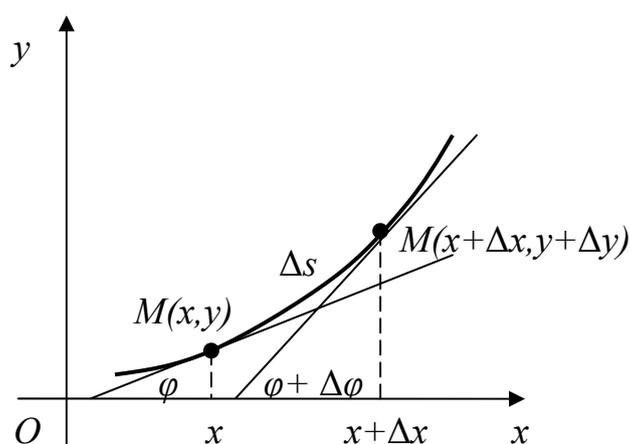
По определению  $k_{ср} = \frac{|\Delta\varphi|}{|\Delta s|} = \left| \frac{\Delta\varphi}{\Delta s} \right|$ . Тогда  $k = \lim_{\Delta s \rightarrow 0} \left| \frac{\Delta\varphi}{\Delta s} \right|$ . Так как  $\varphi$  и  $s$  являются функциями  $x$ , то  $\varphi$  можно рассматривать как функцию от  $s$ , заданную с помощью параметра  $x$ .
