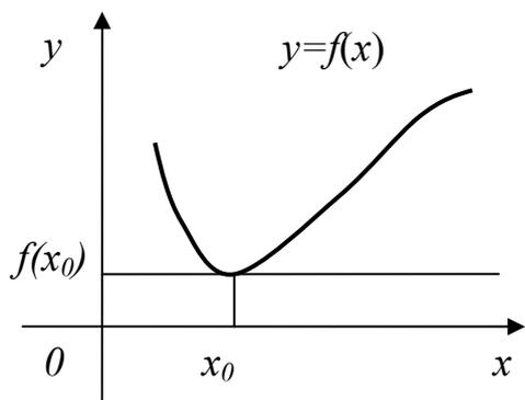
Теорема Ферма имеет простой геометрический смысл: касательная к графику функции  $y = f(x)$  в точке локального экстремума  $(x_0, f(x_0))$  параллельна оси абсцисс.
