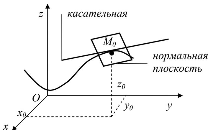
**III. Линия как пересечение двух поверхностей.** Кривая в пространстве может быть задана и как линия пересечения двух поверхностей:  $F(x, y, z) = 0$ ,  $\Phi(x, y, z) = 0$ .
