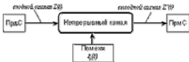
Рис.14. Схема непрерывного канала передачи информации
