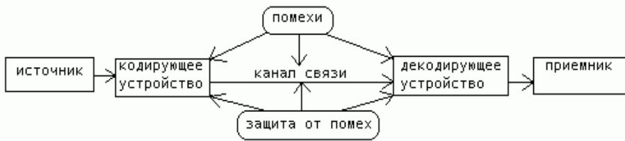
Рис. 2. Схема информационного канала
