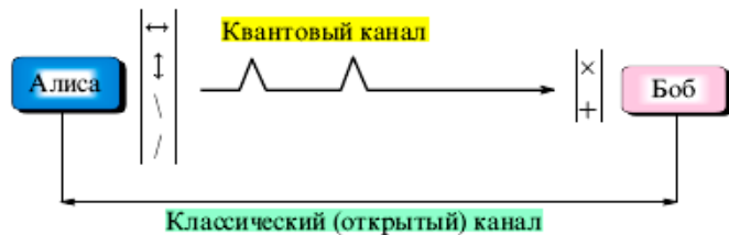
Рис. 4. Последовательность действий для квантовой криптографии при использовании кодировки поляризационных состояний.
