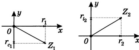
Мы получаем  $Z_1 = (r_1; r_{c1}) = r_1 - r_{c1} i$ , поскольку для емкостного сопротивления вектор реактивного сопротивления отстает на  $\frac{\pi}{2}$  (рисунок слева).
