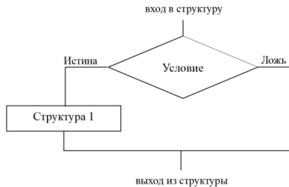
Рисунок 8.1 – Структура «Разветвление» для оператора if
