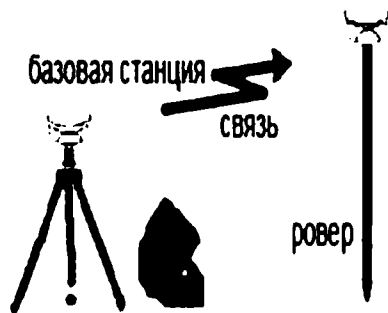
Рис. 65. Принцип работы RTK
