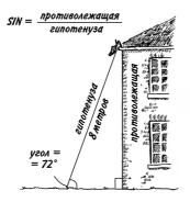
Лестница, стена и поверхность земли образуют прямоугольный треугольник. Если вы измерили угол между лестницей и землей (он равен 72°), то можете вычислить, на какой высоте находится желоб, чтобы не теряться, отвечая потом на вопросы работников скорой помощи.
