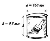
При расчете площади или объема всегда используйте одинаковые единицы измерения. У нас радиус в миллиметрах, а высота в метрах, так что будем считать все в метрах, чтобы в итоге получить кубические метры. Преобразуем радиус: 80 мм = 0,08 м. Теперь подставим r = 0,08 и h = 0,3 в формулу:
