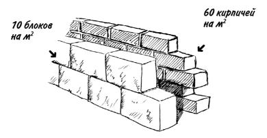
Так что если заблудший дорожный каток мимоходом развалит стену вашего дома, размер которой 5,3 м  $\times$  2,5 м, то на восстановление ее внешней части понадобится 5,3  $\times$  2,5  $\times$  60 = 0коло 800 кирпичей, а внутренней — 5,3  $\times$  2,5  $\times$  10 = примерно 135 блоков. Если бы мой приятель Блейки знал об этом, ему бы не пришлось краснеть, когда каменщику, которого он нанял на день, уже к 11 утра не хватило материалов.
