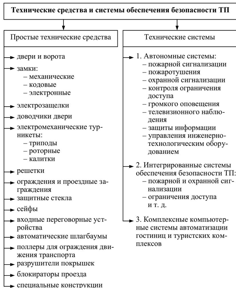
Рис. 4.1. Классификация технических средств и систем обеспечения безопасности туристских предприятий
