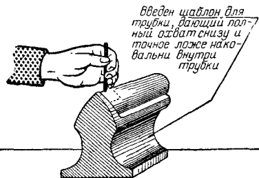
КЛЕПКА ТРУБКИ установочная фаза № 5
