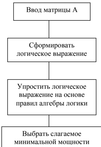
Рис. 2.39. Схема работы алгоритма для нахождения минимального числа покрывающих назначений
