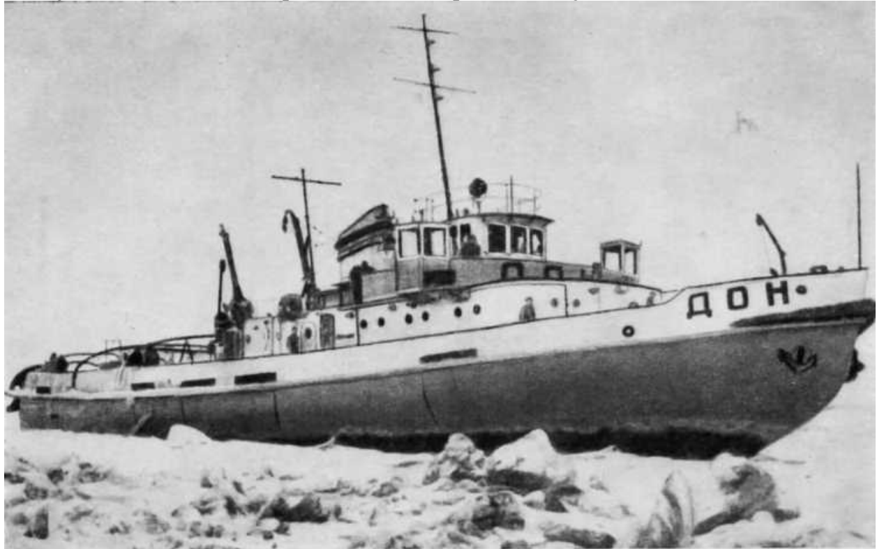
Судно, целиком сваренное методом автосварки под флюсом.
