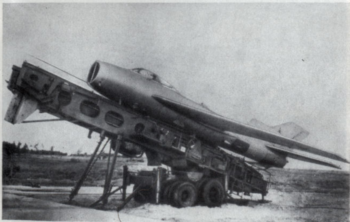
МиГ-19 (СМ-30) на установке для катапультируемого старта.
