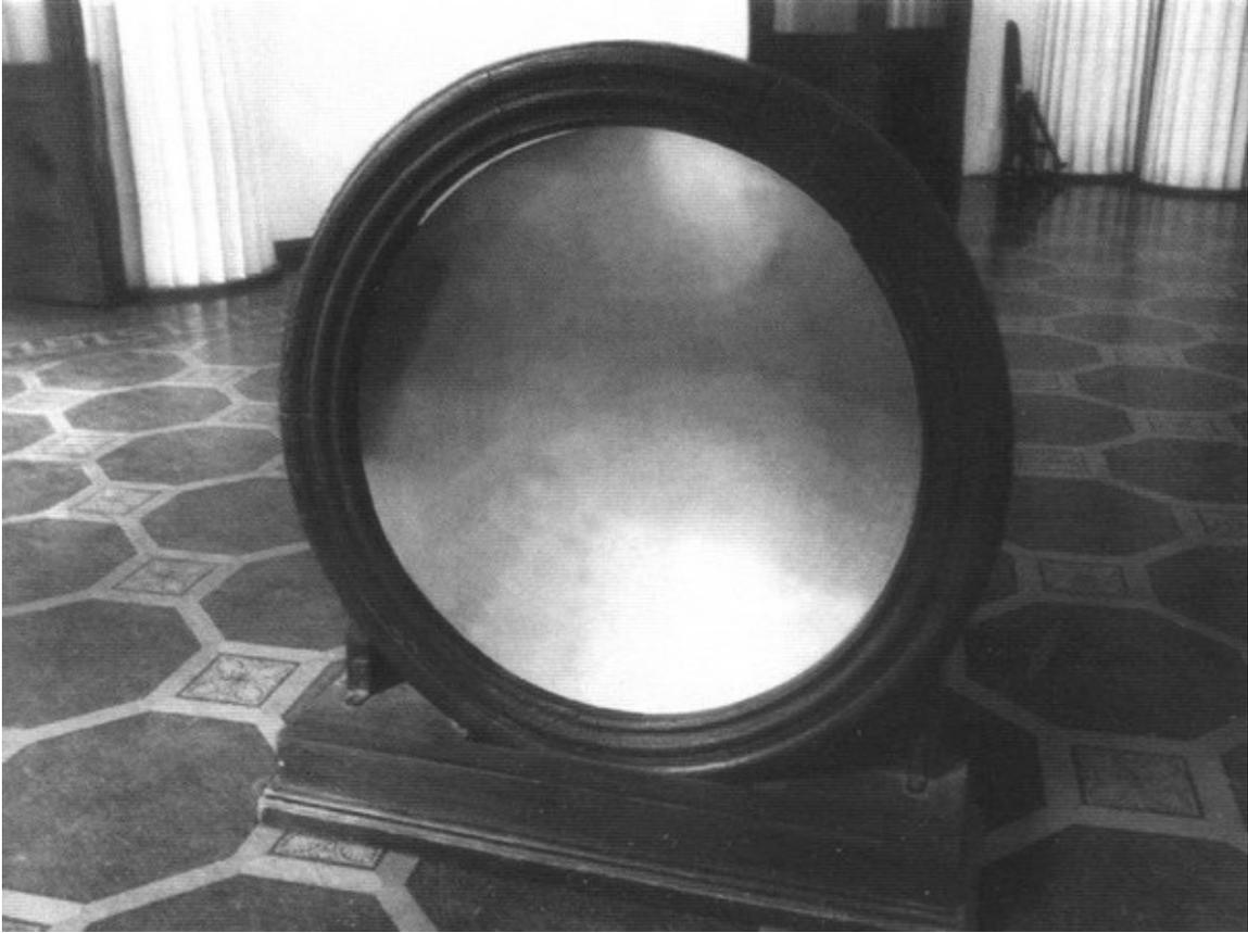
*Металлическое зеркало для ньютоновского телескопа, изготовленное
