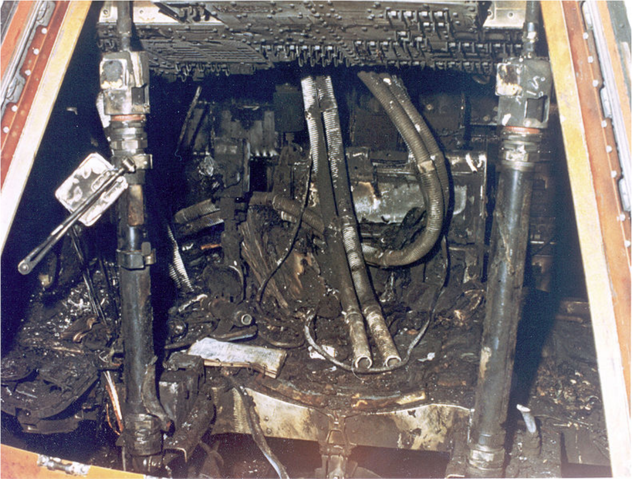
Кабина космического корабля «Аполлон-1» после пожара. 1967 г.
