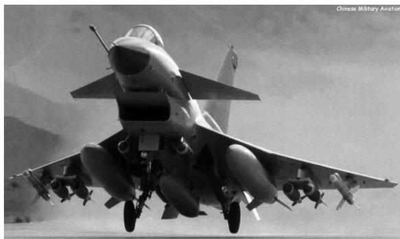
истребителя Цзянь-10: максимальный взлетный вес 19277 кг, максимальная скорость 2,2 М, боевой радиус с дозаправкой в воздухе 1600 км, без дозаправки в воздухе – 550 км. Самолет оснащен различным вооружением, может нести боевую нагрузку до 6000 кг. Стрелково-пушечное вооружение представлено встроенной 30-мм автоматической пушкой.
