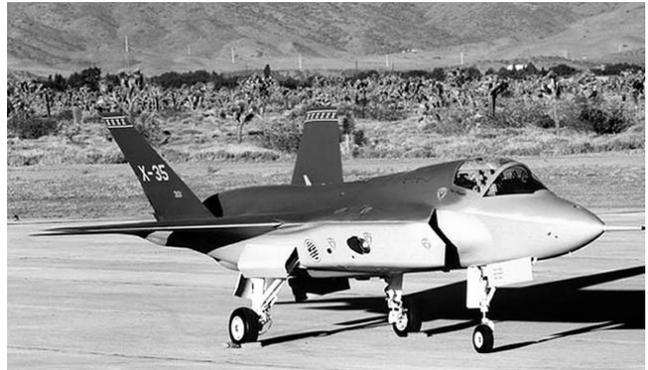
为降低结构重量，X-35 的翼盒采用了单块式结构，将机翼和机身集成为一体，减少了许多接头和连接件。机翼上下蒙皮采用传统的碳纤维环氧树脂复合材料制成，一些温度较高部位采用热强复合材料。垂尾及水平尾翼采用铝合金蜂窝结构，蒙皮为碳纤维热强复合材料。全复合材料垂尾是作为一个整体结构采用聚合物包复的金属模型方法一次固化成形的。
