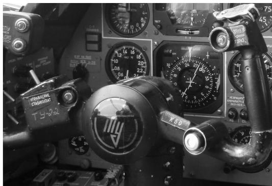
Движением ручки (поворотом штурвала) влево или вправо отклоняются элероны осуществляется наклон (крен) самолёта в нужную сторону - поперечное управление. Педалями вызывается отклонение руля направления – путевое управление. С ростом скоростей полёта повышаются усилия, необходимые для отклонения рулевых поверхностей. Для уменьшения нагрузок на рычаги управления
