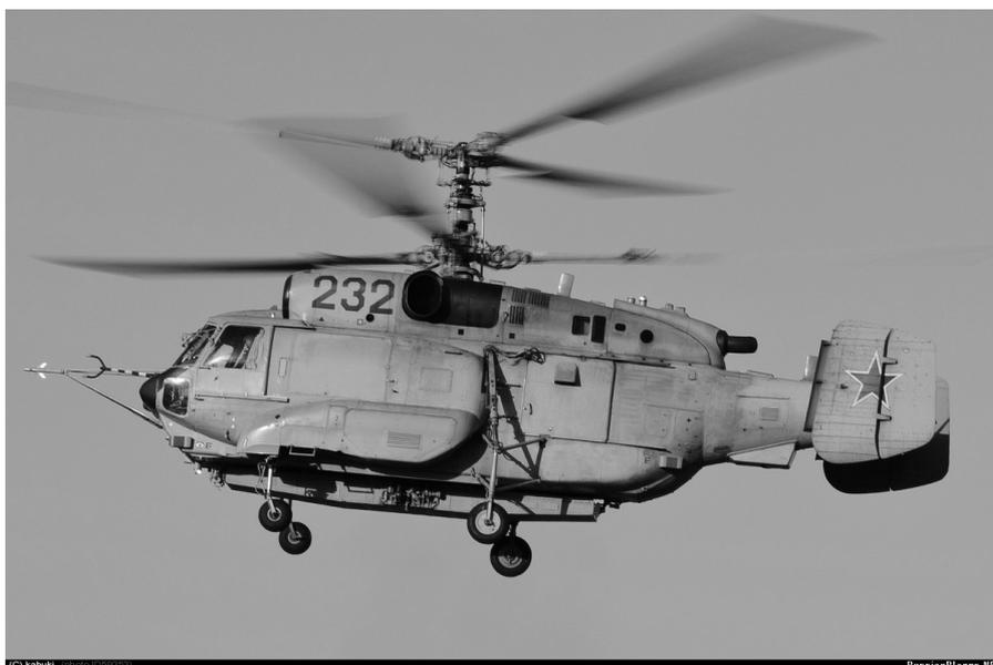
Шасси вертолета выполнено частично убирающимся (подтягивающимся), что обеспечивает бортовой РЛС круговой незатененный обзор. Пилотажно-навигационное оборудование позволяет Ка-31 выполнять автоматизированный полет по заданному маршруту. При использовании в интересах Сухопутных войск Ка-31 может базироваться на небольших неподготовленных площадках вблизи расположения мобильных зенитно-ракетных комплексов, обеспечивая их целеуказанием.
