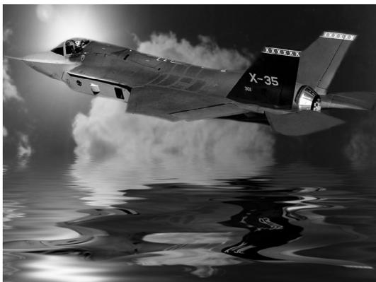
70%。三个型别的主要不同体现在：STOVL 型装有轴驱动升力风扇、三轴转向喷管以及空中受油探管；CTOL 型装轴对称地可探测喷管、内置机炮和空中受油口；CV 型加强了内部结构，并安装了着舰拦阻钩，增大了机翼和尾翼控制面以改善低速进场着舰性能，便大的前缘襟翼和可折叠翼尖增加了机翼面积，提供了额外的航程和有效载荷。
