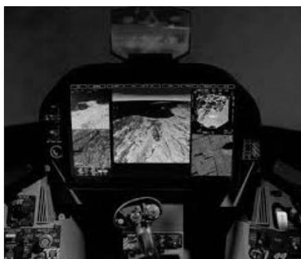
KAISER 电子公司开发的这种基于投射式液晶显示器 (LSD) 技术的新型显示器，降低了大格式显示器的成本，从而使洛克希德·马丁公司在工程制造与发展阶段的 JSF 座舱中采用大格式显示器成为可能。JSF 座舱的另一个特点是没有平视显示器 (HUD)，取而代之的是功能更强大的头盔显示器 (HMD)。洛克希德·马丁公司的 JSF 将采用视景系统国际公司研制的
