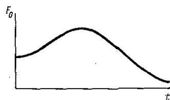
Рис. 4.23. Аппроксимация базового контура частоты основного тона с плавным подъемом
