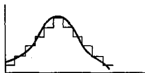
Рис. 3.1. Аппроксимация речевого сигнала с помощью дельта-модуляции
