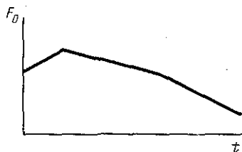
Рис. 4.22. Линейная аппроксимация базового контура частоты основного тона
