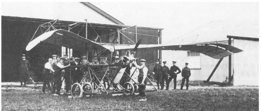
Моноплан D.6. Для лучшей устойчивости концы крыла отогнуты вниз.
