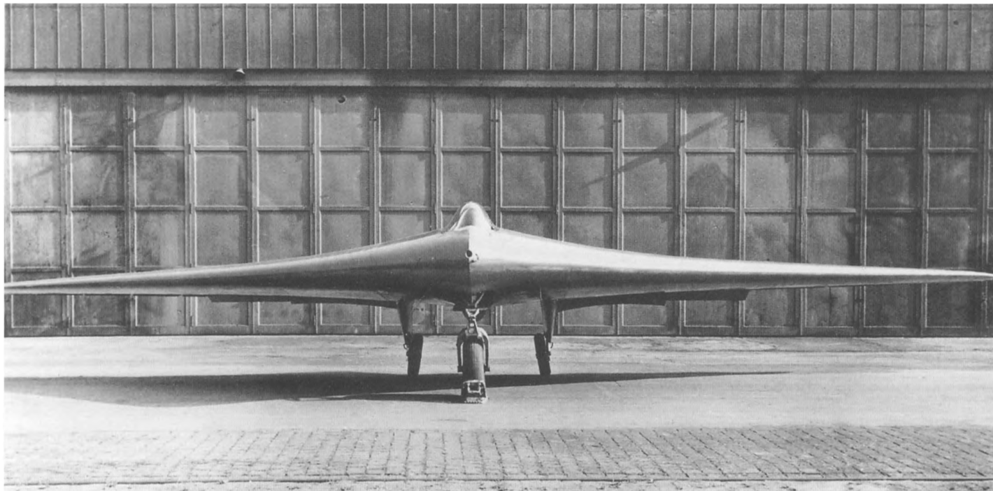
Ho.IXV-1 — безмоторный прототип реактивного истребителя братьев Хортен.
