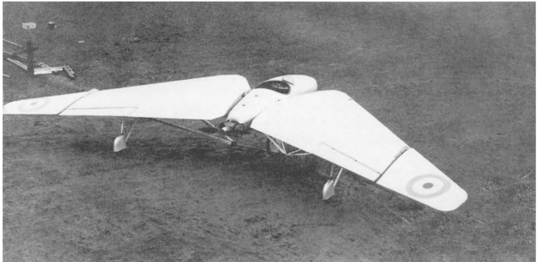
"Птеродактиль" Mk.IA. Хорошо видны внешние поворотные части крыла, служащие для управления самолетом.
