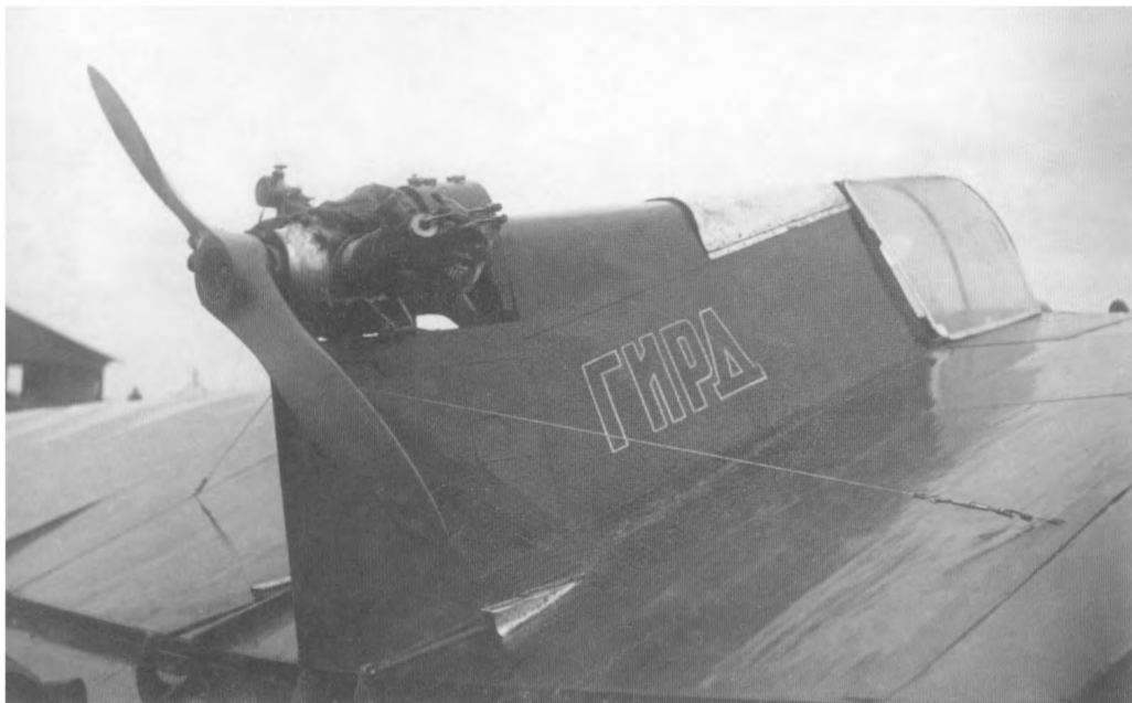
Из-за отсутствия ракетного двигателя РП-1 испытывался с обычным поршневым мотором.
