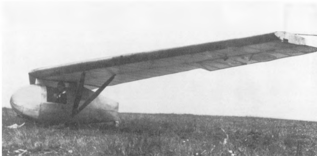
Планер "Шторх-II". Аппарат страдал плохой путевой устойчивостью.
