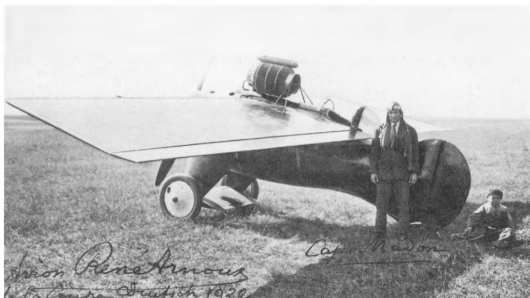
Ж.Мэдон около гоночного моноплана Арну. Недостатком самолета был плохой обзор из кабины из-за расположенного впереди большого бочкообразного радиатора.
