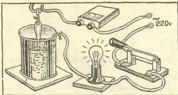
Жестяную банку вымойте с мылом или стиральным порошком, ополосните и заполните раствором для анодирования алюминия: на 100 мл воды – 20 мл серной кислоты (осторожно!). Кислоту можно заменить карбонатом аммония  $(\text{NH}_4)_2\text{CO}_3$  (10 г) или в крайнем случае пищевой содой, растворив ее в воде до насыщения. Вода должна быть дистиллированная, годится и чистая дождевая.
