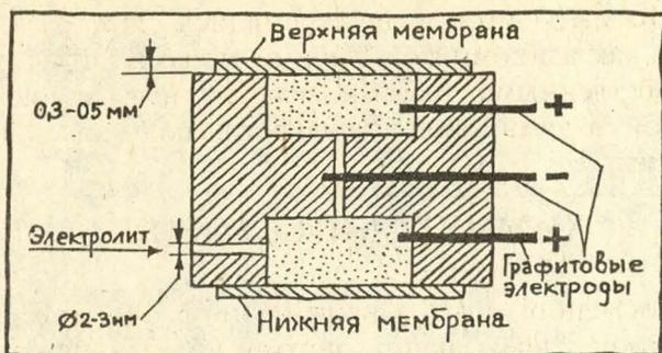
В качестве электродов возьмите толстые грифели для цанговых карандашей. Те места где грифели выходят из корпуса, надо загерметизировать каким-либо клеем. Когда клей высохнет, в перемычке просверлите вертикально очень тонкое сквозное отверстие диаметром не более 0,5 мм. Выбирая для него место, имейте в виду, что это отверстие обязательно должно пройти через средний грифель-электрод.
