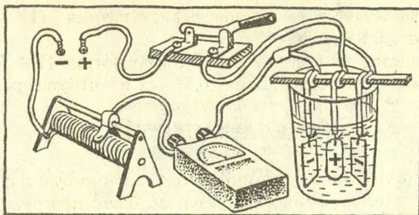
проволочку, подобрав такую высоту, чтобы деталь оказалась на несколько сантиметров выше дна. Соедините деталь с положительным полюсом источника тока. Катоды – стальные пластинки – подвесьте таким же образом. Источником тока могут служить батарейки, но они очень быстро "сядут"; аккумулятор или трансформатор с выпрямителем предпочтительнее.
