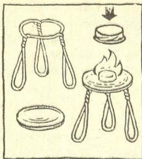
Когда вещество нагревают в стакане, то крышка не нужна. Стакан ставят в водяную баню, но не прямо на дно (так он может перегреться), а на подставку из фанеры или куска дерева. В подставке желательны прорезать отверстия, чтобы вода могла циркулировать. А чтобы дерево не всплывало, подставка должна плотно прилегать к стенкам бани.
