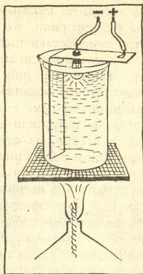
цоколе, самый крайний его участок, соедините с отрицательным полюсом, а полоску жести – с положительным. Обратите внимание: припаивать проводники нельзя, потому что во время опыта припой может расплавиться. Надо придумать механический контакт или же использовать патрон от старого карманного фонаря.
