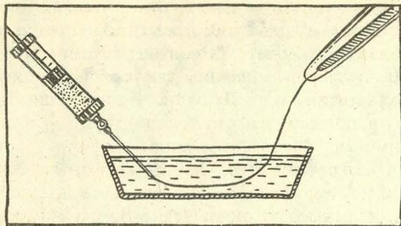
из раствора нить? Так же, как на заводе, — продавливая раствор через узкое отверстие, причем в раствор серной кислоты — в нем фиксируется форма нити.
