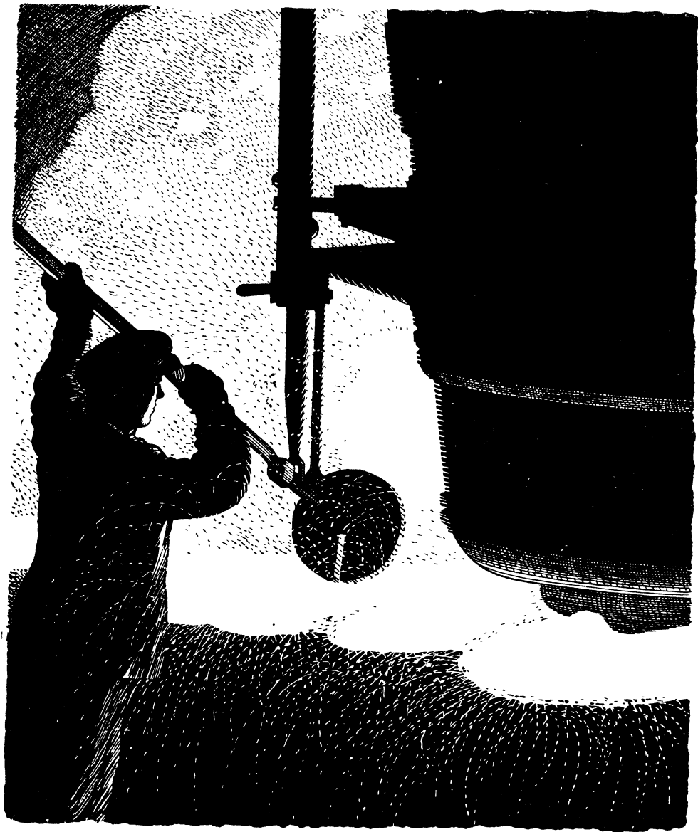
Разлив готовой стали в изложницы.
