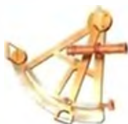
Секстант измеряет высоту звезд и солнца над горизонтом.
