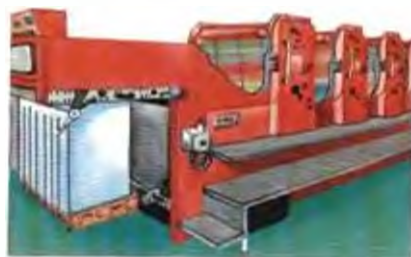
Типографские машины отпечатывают 10 тыс. листов в час. Затем листы механически переплетаются.
