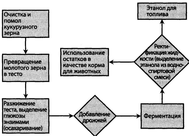
Рис. 7.2. Использование технологии сухого помола для выделения этанола из кукурузных зерен, а также получения побочного продукта, идущего на корм животным
