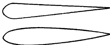
Рис. 4. Различные профили крыла
