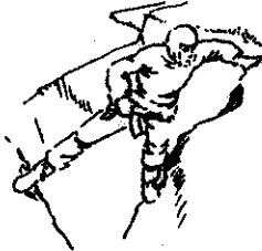
г) вылезание из глубокой траншеи с опорой ногами и руками
