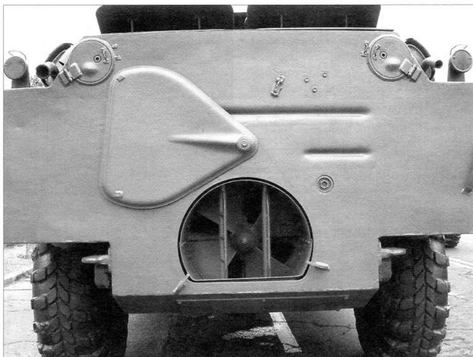
Вид на корму БРДМ-2 с поднятой заслонкой водомета
