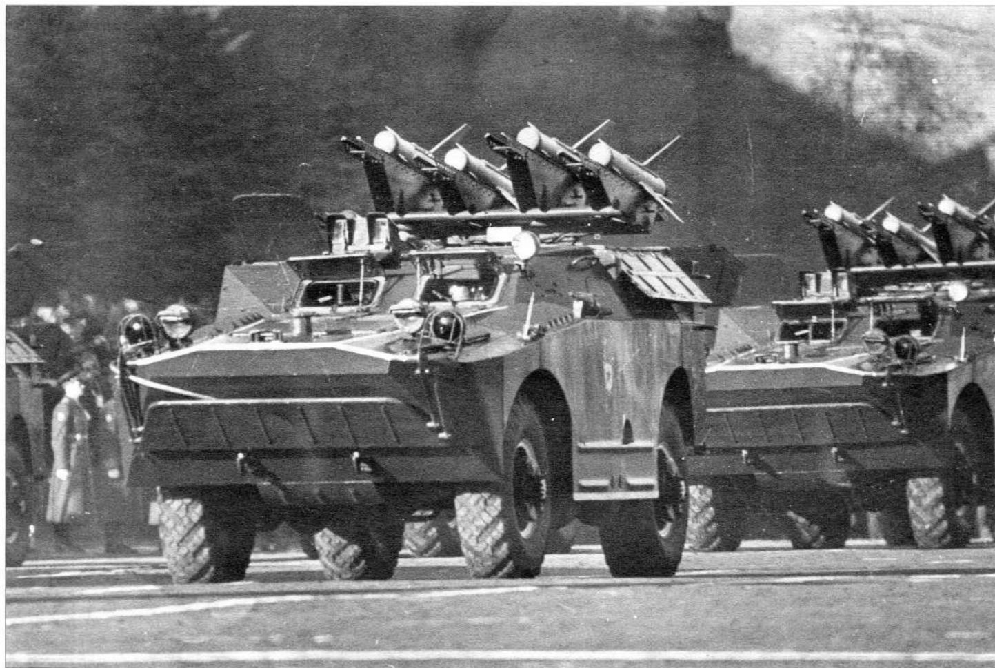
Боевые машины 2П32 с ПТРК 2К8 «Фаланга» во время парада на Красной площади. 7 ноября 1967 года
