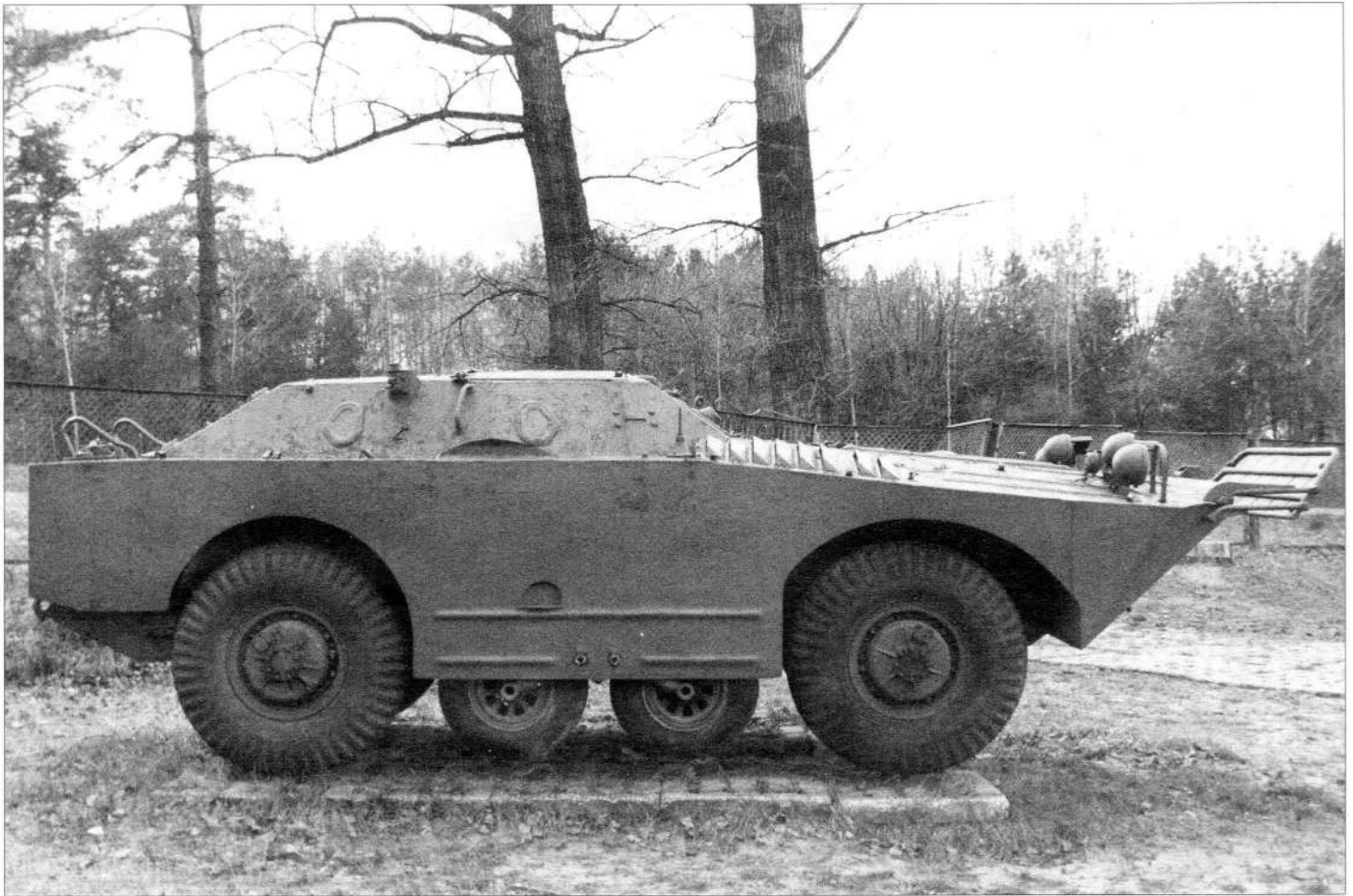
БРДМ, вид сбоку. Хорошо видны дополнительные колеса
