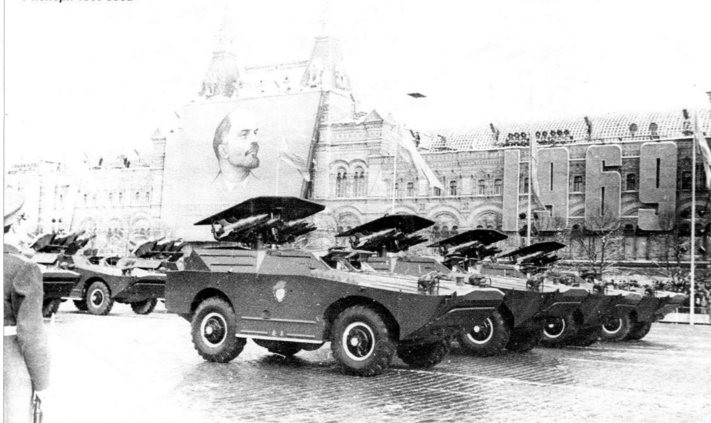
Боевые машины 9П110 с ПТРК 9М14 «Малютка» на Красной площади. 7 ноября 1969 года
