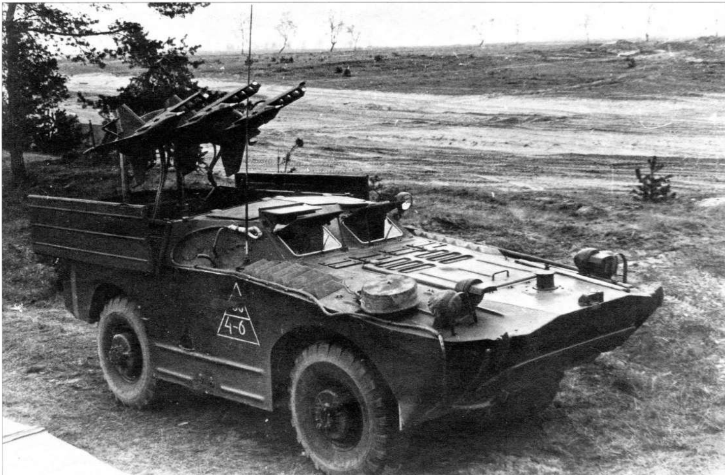
Боевая машина 2П27 с ПТРК 2К16 «Шмель». Пусковая установка в боевом положении
