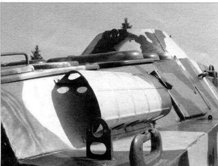
Защитный чехол глушителя двигателя БРДМ-2. Фото Н. Якубовича
