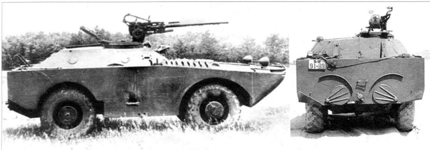
Усовершенствованный образец БРДМ ГАЗ-40П, 1962 год. Машина вооружена 14,5-мм пулеметом КПВТ и имеет два водомета. Изготовлен опытный образец
