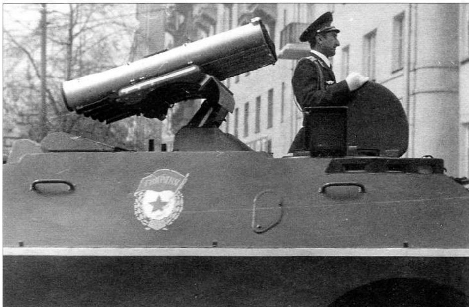
Вид крупным планом на ПТРК 9К133 «Конкурс», установленный на боевой машине 9П148
