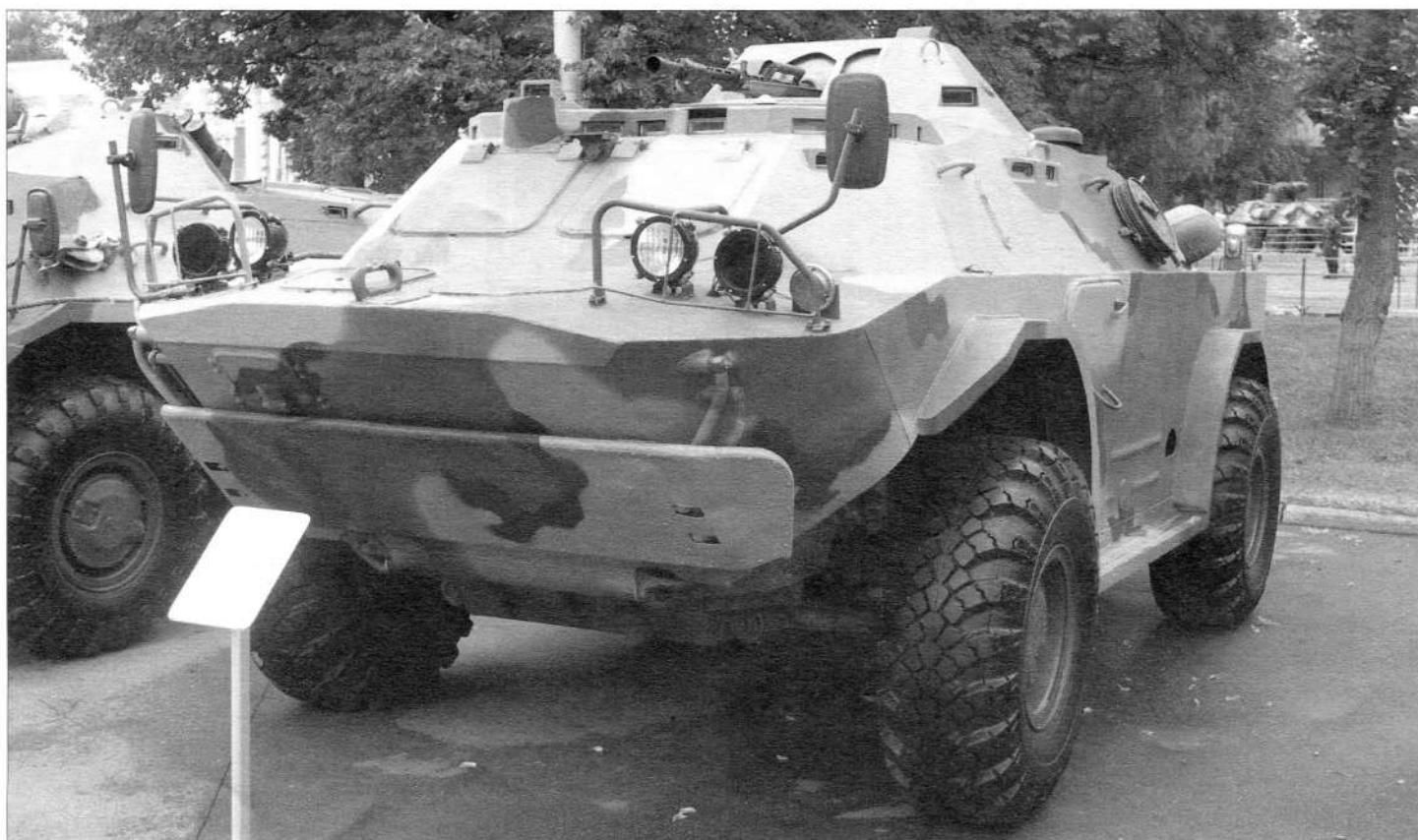
БРДМ-2Д, модернизированная в СКБ КЭО ГАЗ в 1999 году. Подвеска машины унифицирована с БТР-80
