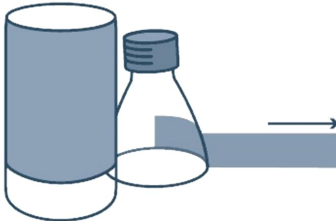
**8. Возьмите еще одну прозрачную пластиковую линзу от фонаря и просверлите в ее центре маленькое отверстие. Подрежьте линзу по краям так, чтобы ее диаметр стал чуть меньше диаметра бутылки. Вставьте линзу в верхнюю часть бутылки так, чтобы она оказалась на 1,3 см выше нижнего обреза.**
