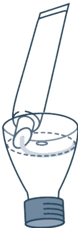
**10. Приклейте к обрезу верхней части бутылки по всей окружности кусочки прозрачного скотча по 2,5 см длиной.** Благодаря этому верхняя часть будет легко входить в нижнюю и выходить из нее. Скотч также сделает соединение более герметичным и будет удерживать вместе обе части бутылки при ее использовании в качестве тайника.
