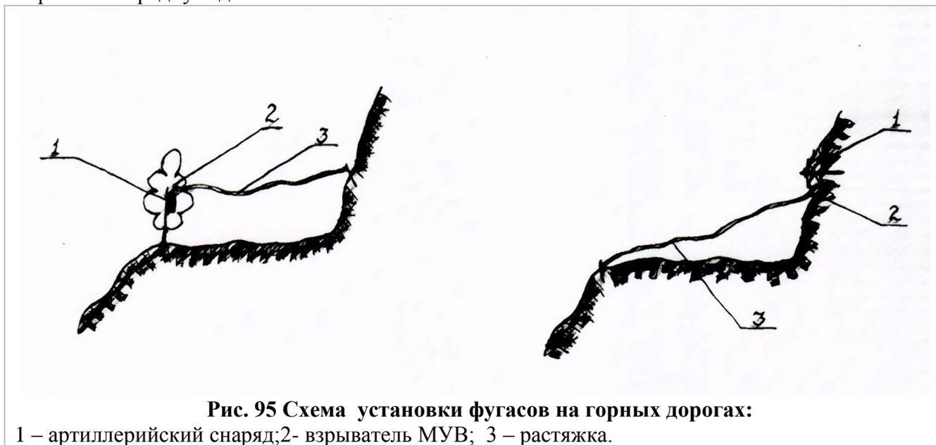
Для воспрепятствования продвижения федеральных войск по руслам горных рек противник часто устанавливал фугасы и противотанковые мины прямо в воде. В населенных пунктах боевики использовали управляемые фугасы, приводящиеся в действие от работающей электросети. В полотне дороги ставили (как правило, на неизвлекаемость) заряд массой 5-10 кг. В расположенный рядом на столбе плафон электрического освещения монтировали осколочную мину (рис. 96).
