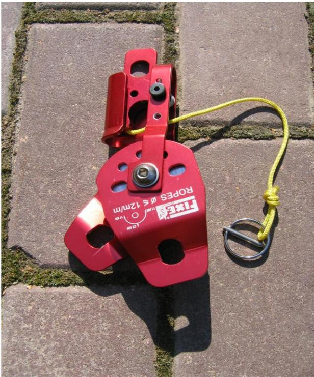
5. Блок-ролик с зажимом (FIXE)
