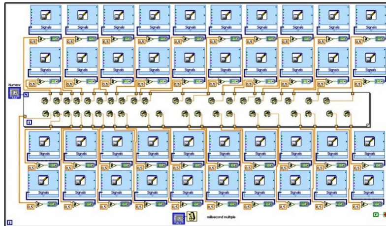
Рис.9. Блок-диаграмма MODEL-02-2021 , состоящая из 40 независимо работающих элементов, каждый из которых в каждой итерации генерирует одно случайное число от «0» до «1», в результате на одномерной оси «X» образуется массив, состоящий из 40 точек. Одна их часть всякий раз оказывается в левой части оси (от 0 до 0,5), а другая – в правой (0,5 - 1,0).
