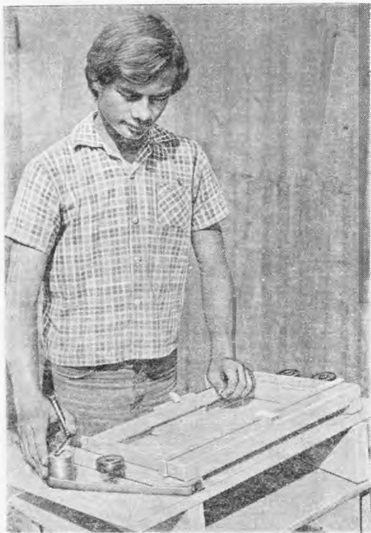
Рис. 16. Станок для оснащения рамок проволокой
