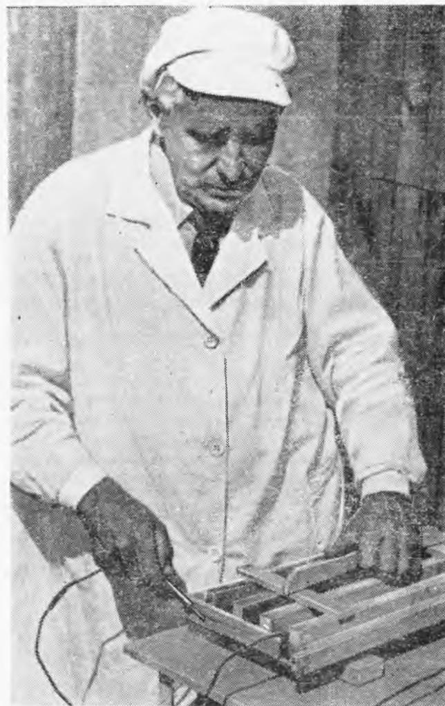
Рис. 17. Приспособление для электронаращивания рамок
