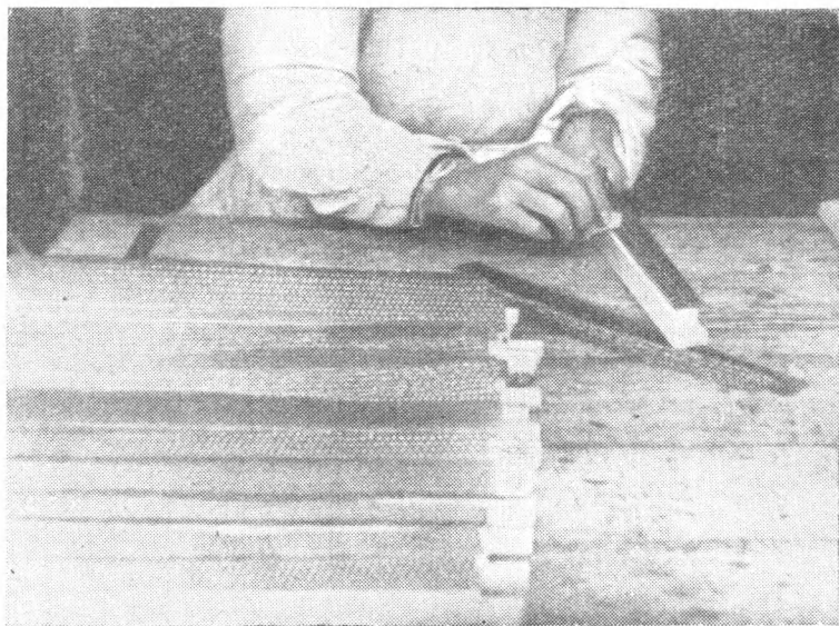
Рис. 39. Подготовка строительных планок; к верхним брускам прикрепляют узкие полоски искусственной вошины.
