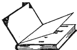
Рис.66. Укрепление сношенных уголков книжно- го переплета
