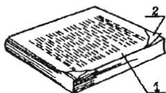
Рис.5. Укрепление целых, но сильно затертых уголков книжных листов конденсаторной или микалентной бумагой: 1 - поврежденный лист книги; 2 - усиленные подклейкой тонкой бумаги уголки листа
