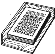
Рис.16. Уголков ящик для сборки стопы листов или тетрадей
