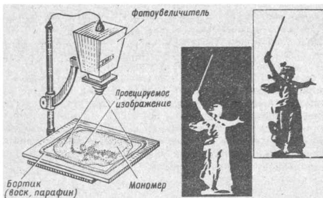
Рис. 187. Способ получения полимерной объемной фотографии
