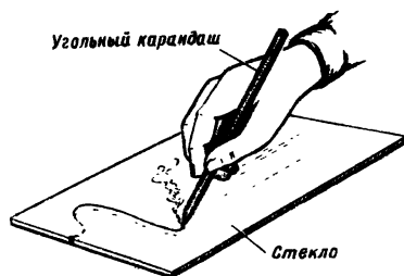
Рис. 171. Резка стекла без алмаза
