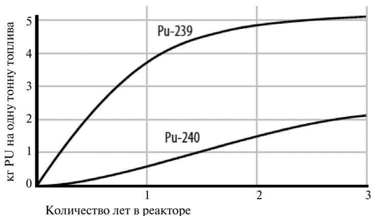
Рис. 1. Динамика накопления плутония-239 и плутония-240 в топливе типичного легководного реактора в течение трех лет (см.: Carson M. 1993. Explosive properties of reactor-grade plutonium. Science and Global Security. Vol. 4. P. 111–128)
