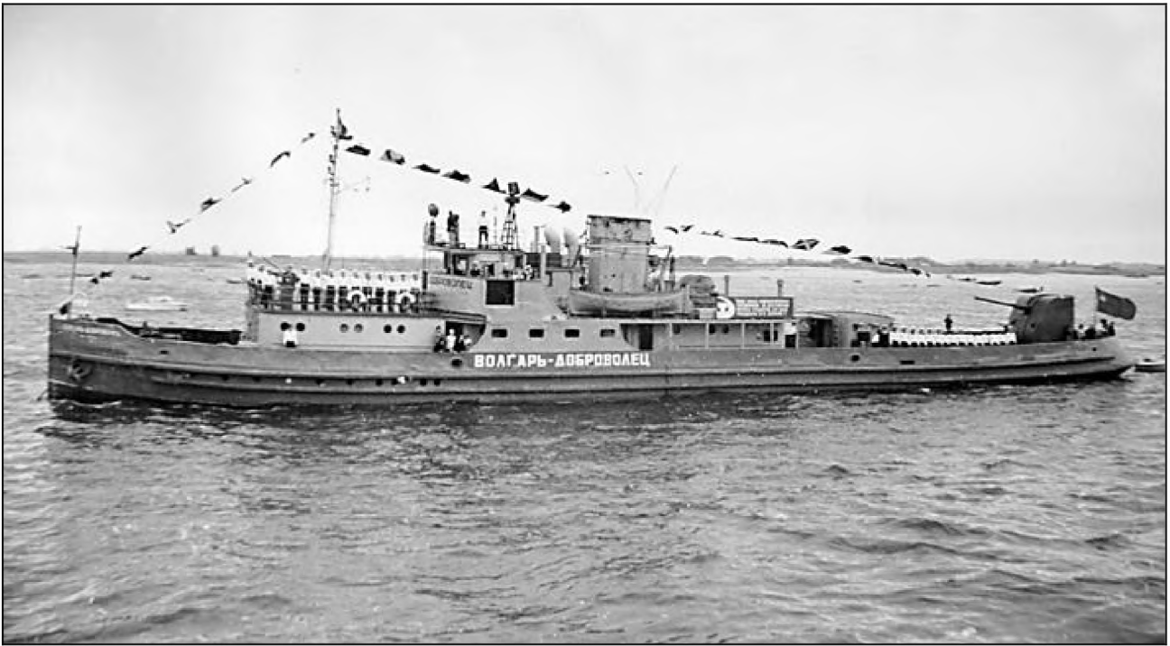
Бывший буксир «Матвей Башкиров», в Красной флотилии - «Волгарь-доброволец», а в 1960-е годы мемориальное судно-музей. Длина 57,7 м., ширина 8,9 м., осадка 1.5 м., скорость хода 11 уз. Стальная обшивка корнуса и палубы.
