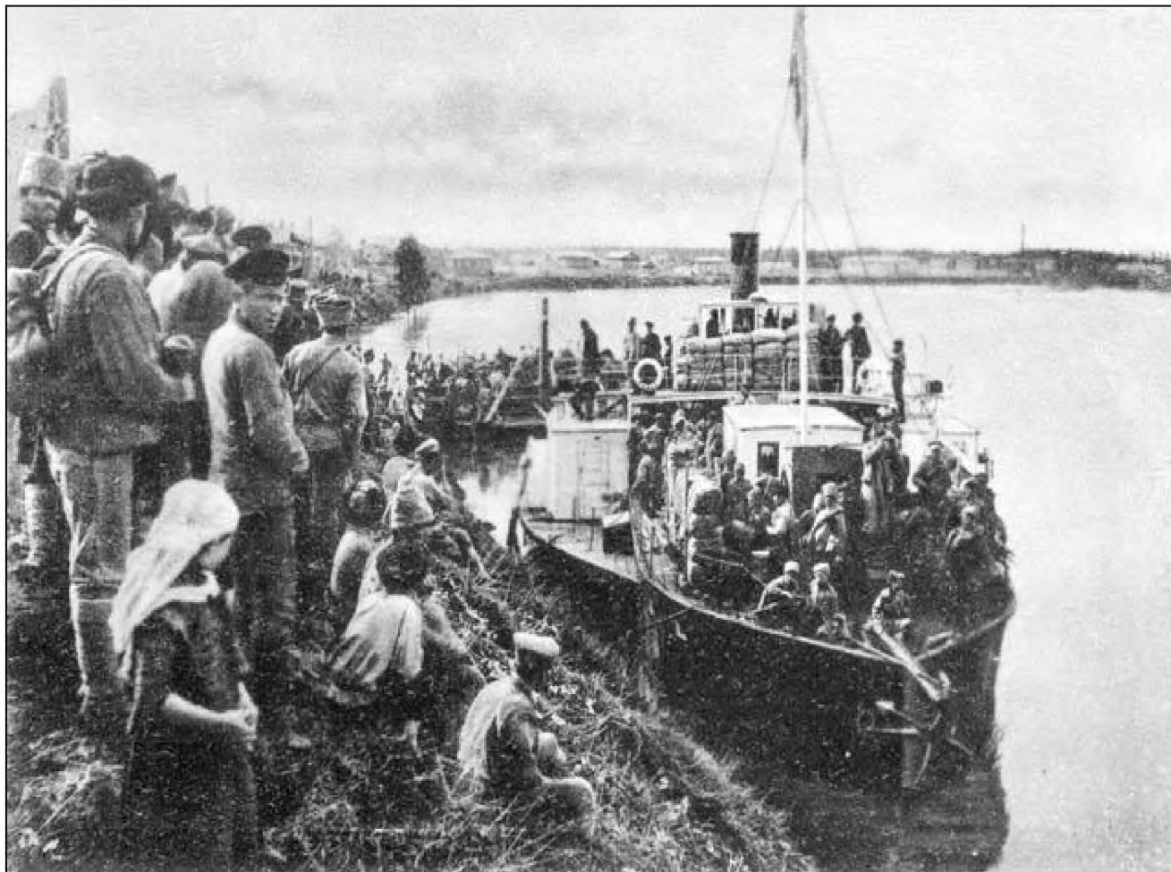
Импровизированный «бронепароход» на р. Вятке. Видны мешки с песком, прикрывающие ходовую рубку и надстройку корабля.
