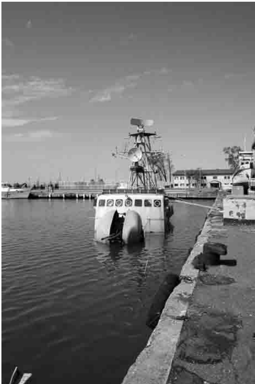
Потопленный грузинский ракетный катер «Диоскурия» (бортовой № 303) – бывший греческий Р17 «Ипоплоиар-хос Бацис» французской постройки типа «Ла Комбатант II» (водоизмещение 255 т, вооружение: две 35-мм пушки Эрликон).
