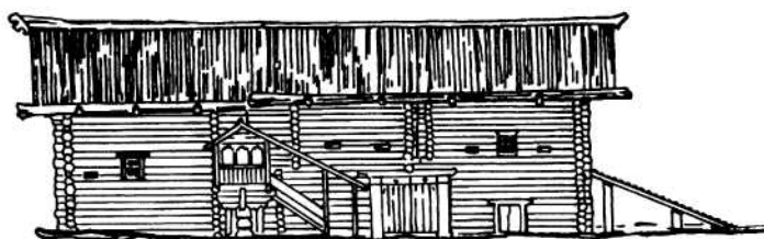
Рисунок 48 – Дом-шестистенок (первая половина XIX в.) в с. Таратино Архангельской области: а) – фасад; б) – боковой фасад; в) – план 1 – изба; 2 – заулоч; 3 – горница; 4 – сени; 5 – двор; 6 – светелка; 7 – зимовка; 8 – взвоз; 9 – крыльцо
