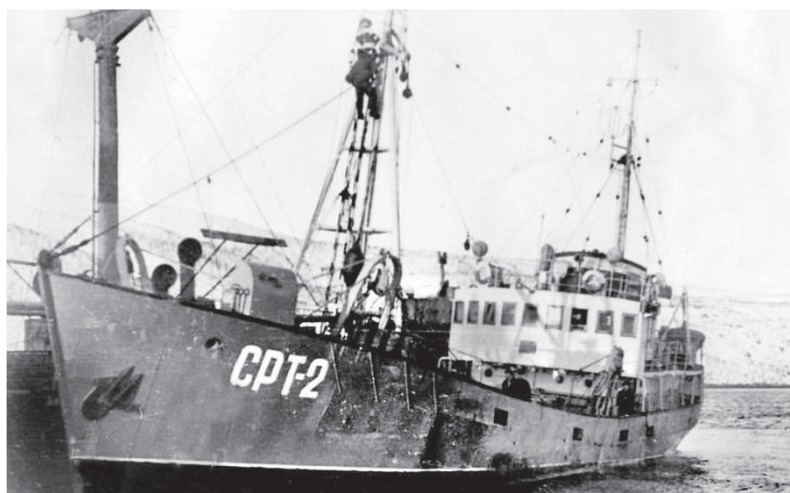
Средний рыболовный траулер мурманской постройки с танковым двигателем
