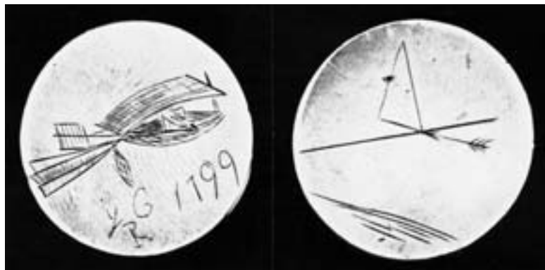
Изображение летательного аппарата и диаграмма действующих на крыло сил, выгравированные Дж.Кейли на серебряном диске.
