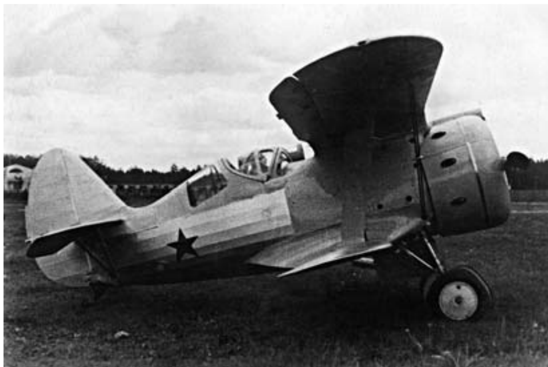
Истребитель И-153 с гермокабиной «мягкого типа»
