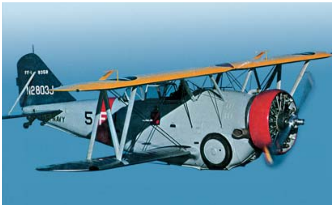
Грумман FF-1 – первый серийный самолет с убирающимся шасси
