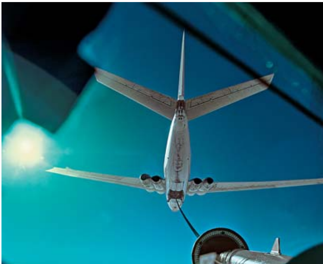
Дозаправка самолета по методу «шланг-конус»
