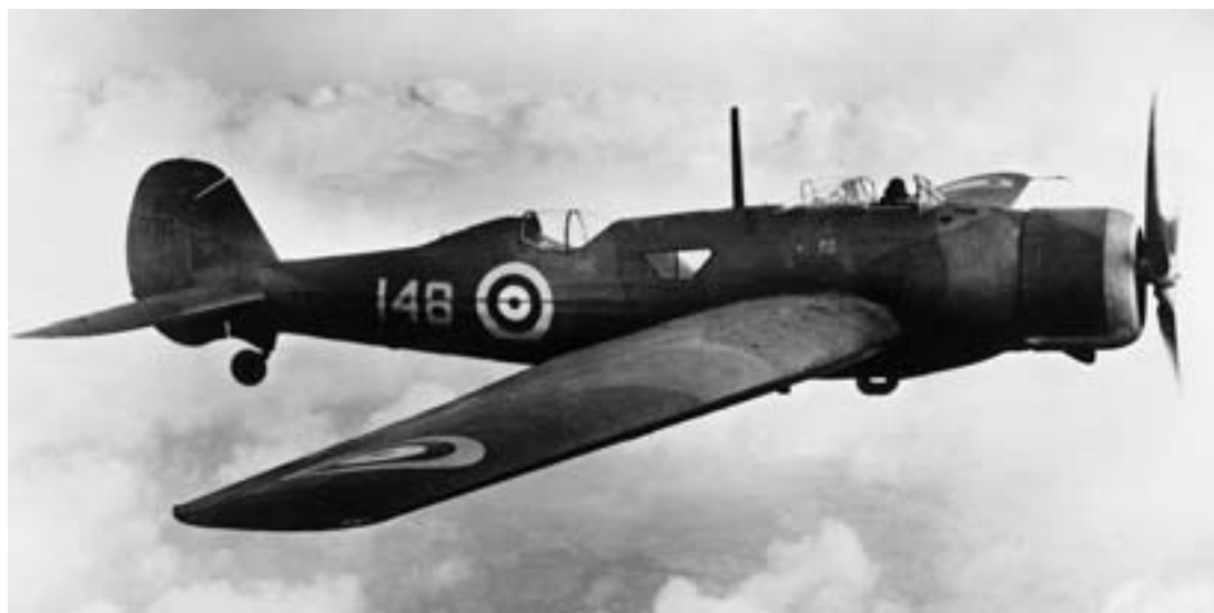
Самолет геодезической конструкции Виккерс «Уэллсли»
