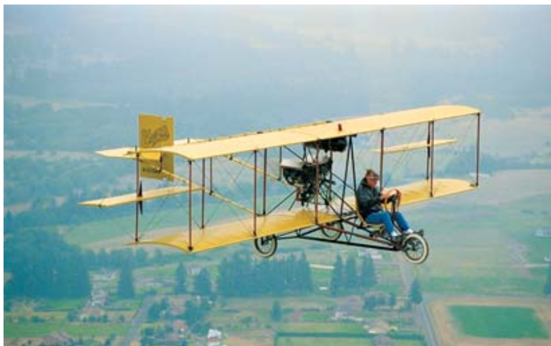
Биплан Г.Кертисса с межкрыльевыми элеронами
