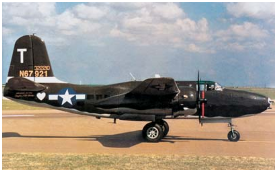
Дуглас А-20 в варианте штурмовика. В носу фюзеляжа вместо кабины штурмана находился пушечный отсек
