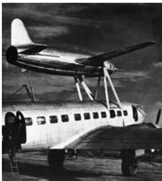
Первый экспериментальный самолет с ПВРД Ледюк 001 мог взлетать только с самолета-носителя
