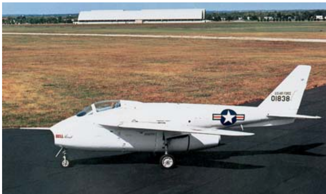
Белл Х-5 – первый реактивный самолет с крылом изменяемой стреловидности
