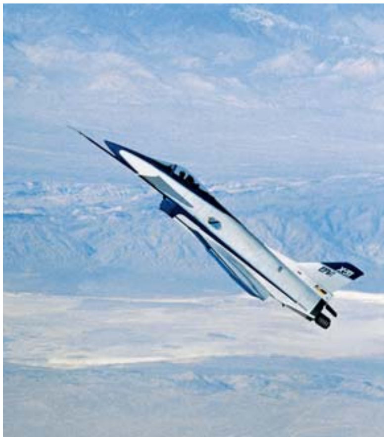
Самолет Х-31. Видны створки на сопле двигателя, управляющие направлением вектора тяги
