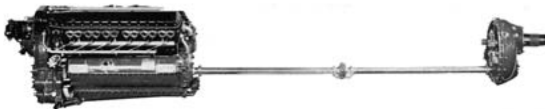
Силовая установка самолета P-39
