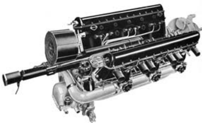
Мотор-пушка фирмы «Испано-Сюиза»
