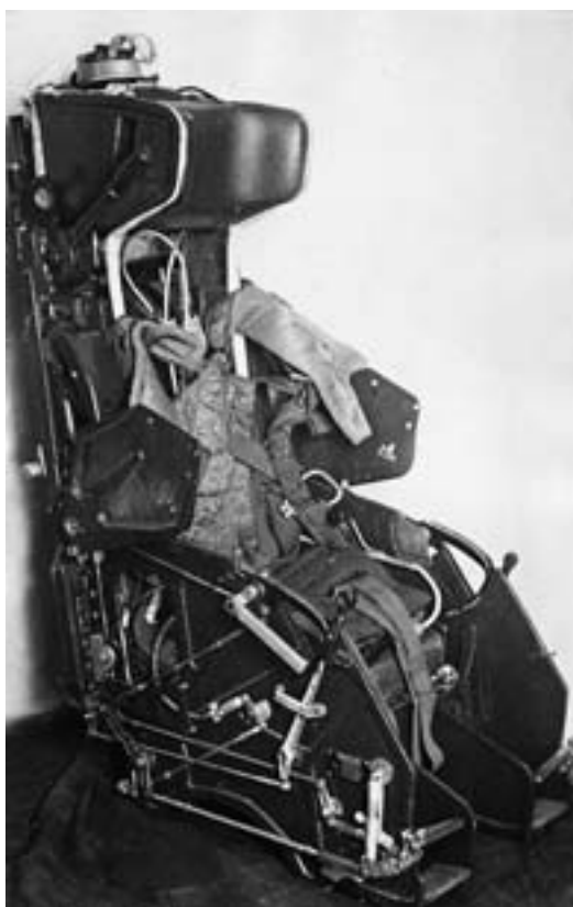
Катапультируемое кресло KC-3, разработанное в ОКБ П.О.Сухого
