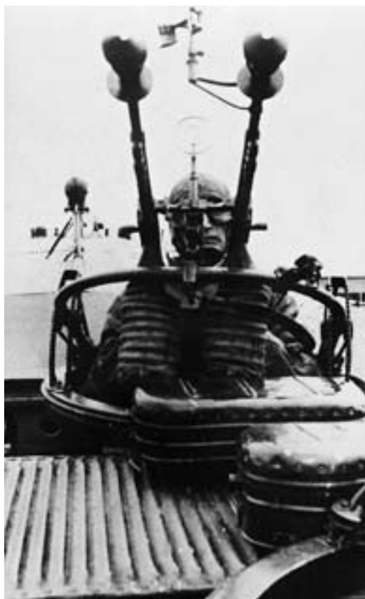
Пулеметная турель на ТБ-3
