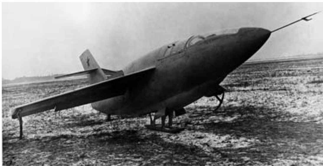
Аппарат «5» испытывался в безмоторном варианте
