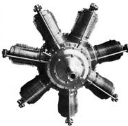
Французский ротативный двигатель «Гном» мощностью 80 л.с. расходовал за час 0,4 кг топлива на одну лошадиную силу и весил 90 кг
