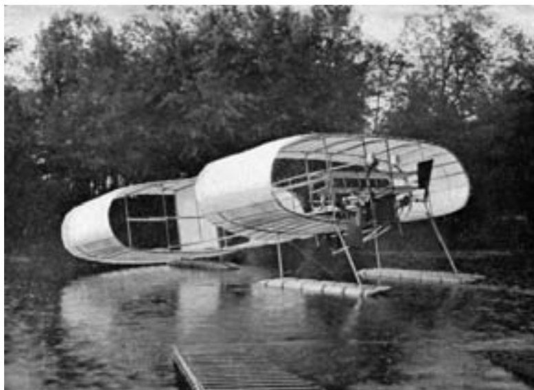
Созданный по типу коробчатого змея самолет Блерио-3
