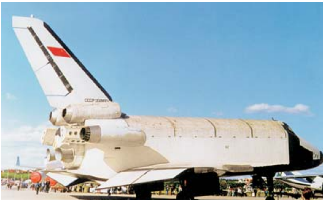
Турбореактивный аналог «Бурана» БТС-002 построили для изучения пилотажных характеристик будущего ВКС в плотных слоях атмосферы
