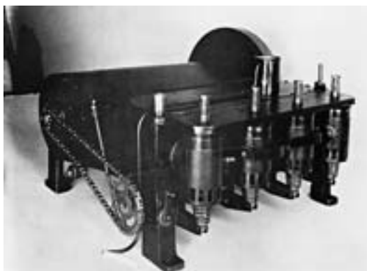
Двигатель самолета братьев Райт
