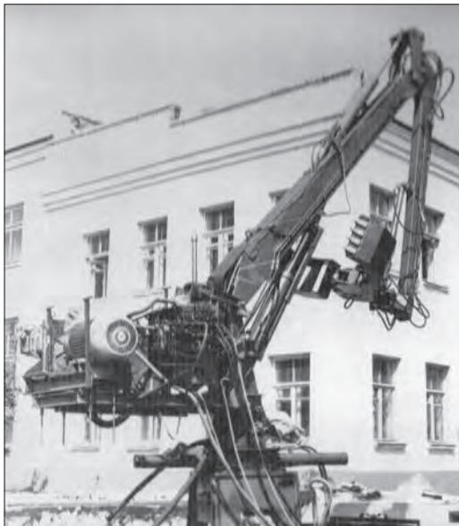
Дистанционно-управляемый манипулятор на базе монитора «Форестери», предназначенный для сборки радиоактивных предметов, выброшенных на кровлю
