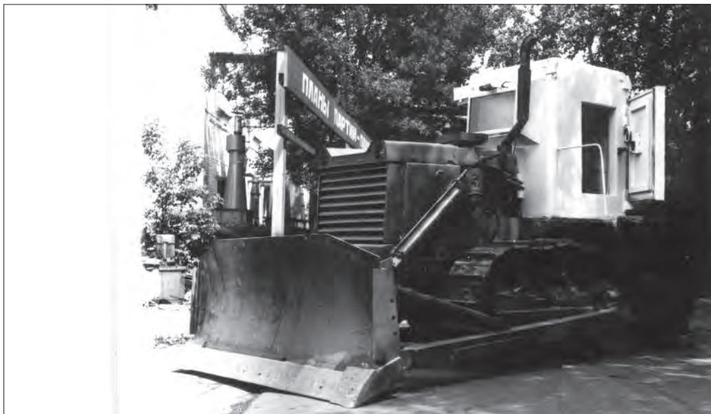
Бульдозер, оснащенный биозащитной кабиной
