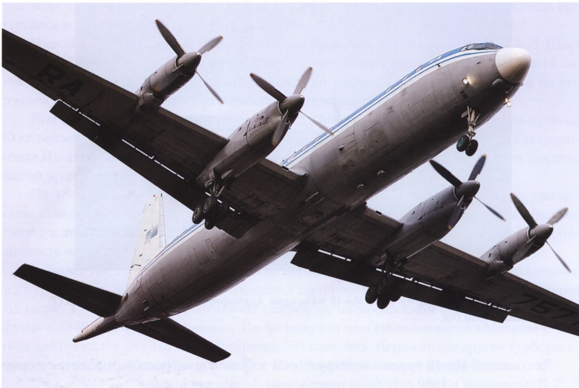
Четыре турбовинтовых двигателя оказались экономичнее, чем два турбореактивных самолета Ту-104
