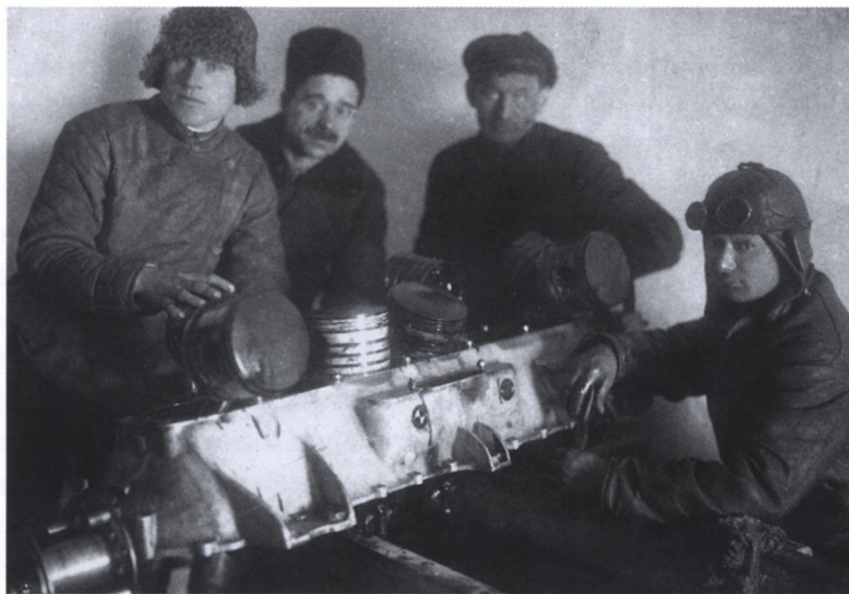
Переборка двигателя БМВ самолета «Юнкерс» во время его пребывания в Перми. Крайний справа, вероятно, авиамеханик самолета Х. С. Клочко. Ему помогают мастера Пермского авторемонтного завода (будущего завода им. Дзержинского). Июль 1925 года
