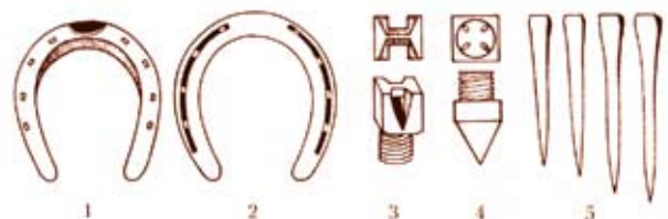
Ковочные материалы: 1 — верхняя поверхность подковы; 2 — нижняя поверхность подковы; 3 — винтовой четырехугольный съемный шип; 4 — винтовой конусообразный шип; 5 — гвозди
