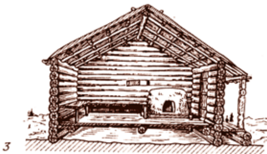
Рис. 2. Древнерусское жилище VII—XIII вв. 1 — полуземляночное жилище VIII—X вв., 2 — полуземляночное жилище XI—XIII вв., 3 — наземное срубное жилище XI—XIII вв. (схема-реконструкция П. А. Раппопорта, 1975)
