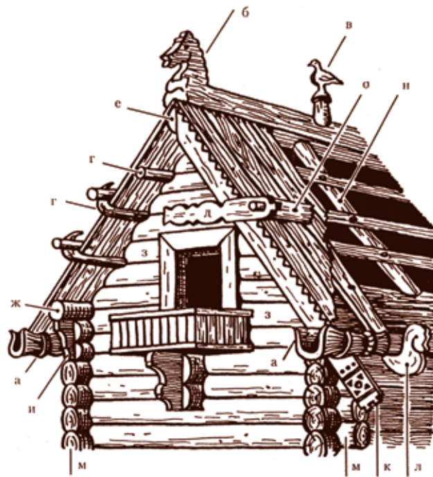
Схема устройства крыши на самцах (по М. В. Красовскому): а — желоба; б — охлупень; в — стамик; г — слези; д — огниво; е — князевая слега («кнес»); ж — повальная слега; з — самец; и — повал; к — причелина; л — курица; м — пропуск; н — бык; о — гнёт.
