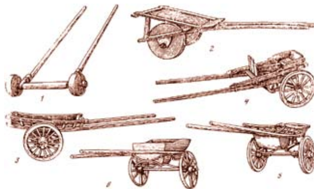
Типы двуколок: 1 — медведки. Бухтарма; 2 — полк. Европейский Север; 3 — водовозка. Забайкалье; 4 — таратайка. Тобольская губ.; 5 — рессорка. Забайкалье; 6 — качка. Краснодарский край
